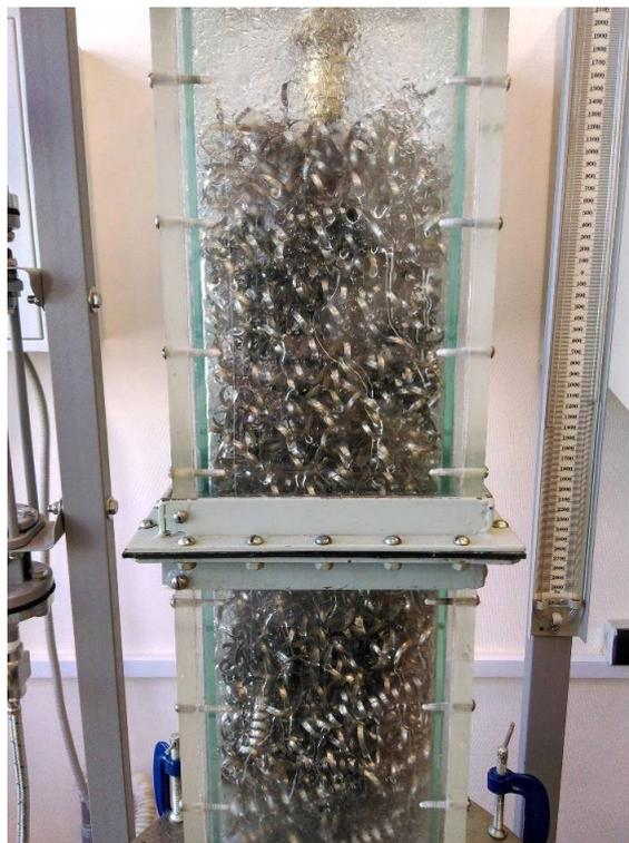
Рис. 10. Экспериментальный блок оросителя (фото автора)
