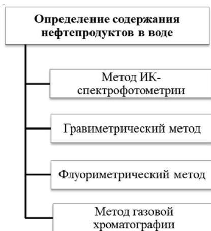
Рис. 1. Методы определения нефтепродуктов в воде
