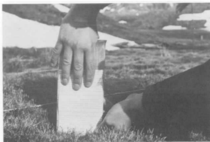
Рис. 1. Процесс установки льняного полотна в почву на глубину [20]
