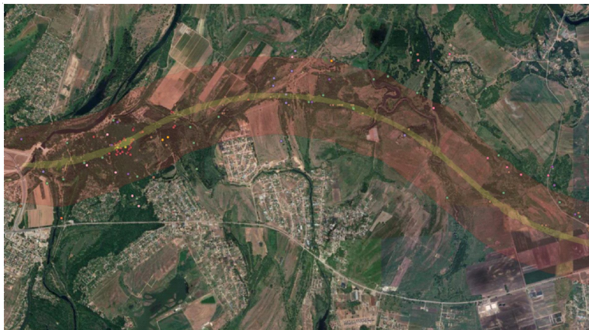
Рис. 3. Схема расположения объекта (оливковый тон – границы зоны временного отвода; розовый тон – граница 500-меровой зоны влияния Объекта; точки – местонахождения редких видов)
