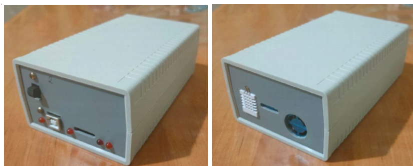
Рис. 3. Малогабаритный пылемер ПИКМА-1
